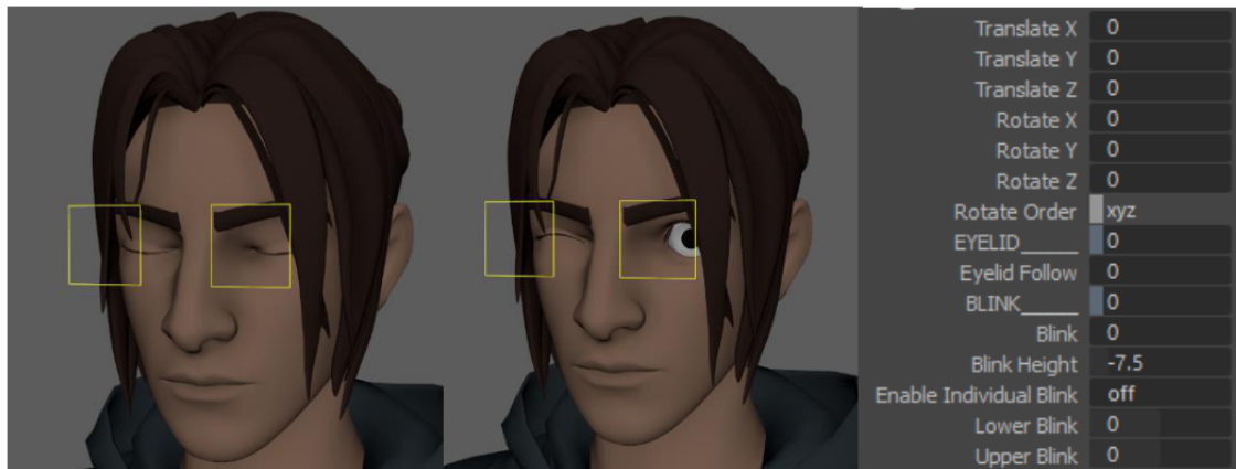
Ilustración 23: Sistema de control de los párpados. Se pueden ver los atributos.
